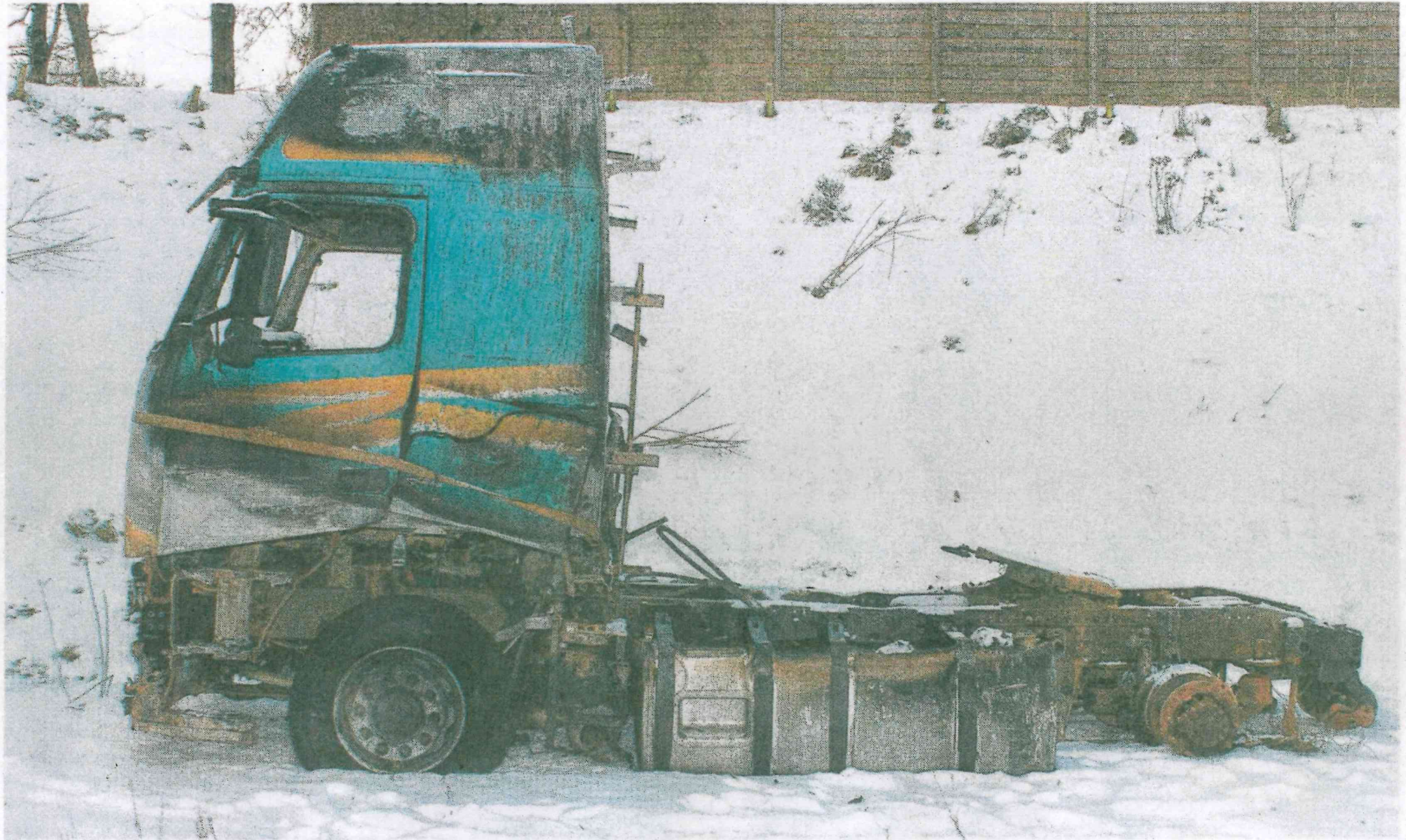
Dieser Sattelschlepper brannte Mitte Dezember auf der Fahrt nach Koblenz aus – die Radmuttern waren entfernt worden.
